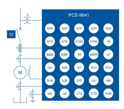
Защита от замыканий на землю с направленном элементом. Кривые IDMT подджерживает стандарт IEC и ANSI.
